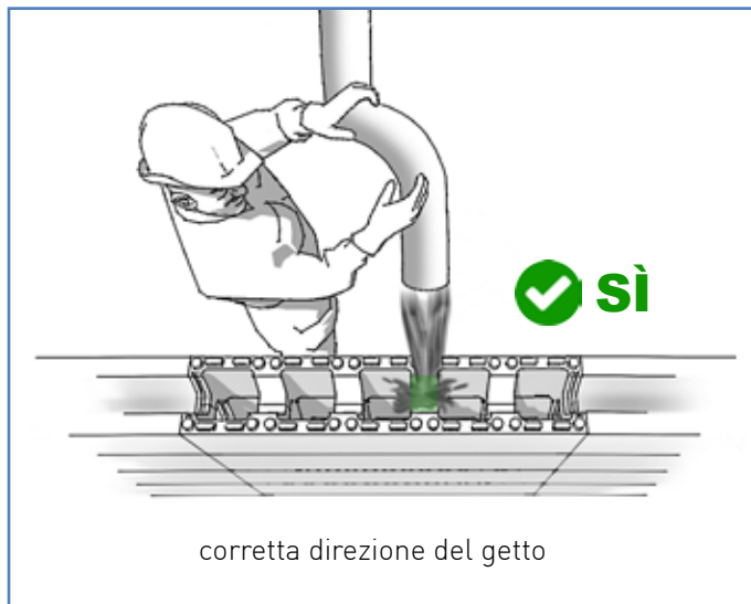
Procedura per il getto di C.A. all'interno dei casseri
